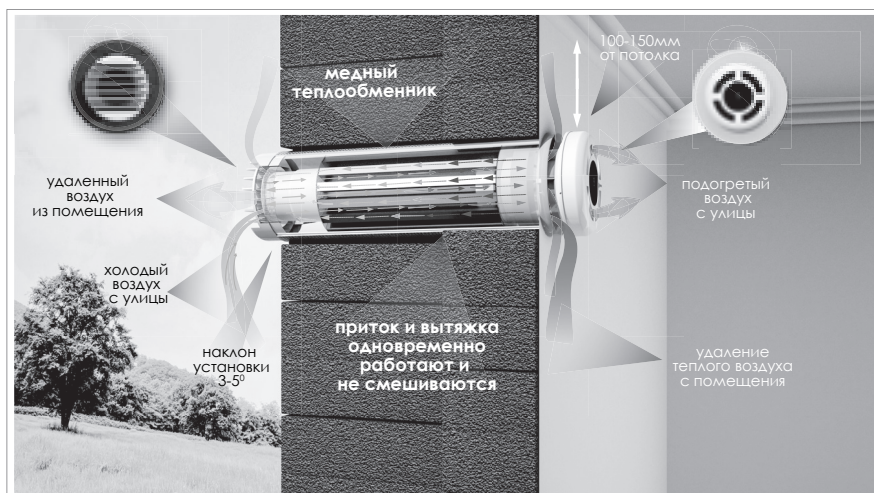
Рис.1. Принцип работы рекуператора PRANA-150, PRANA-200С, PRANA-200G
