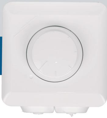
Потенциометр SDP-X10K-NA разработан для управления оборудованием с бесступенчатым управляющим сигналом. Напряжение питания находится в диапазоне 0—24 VDC. Выходное напряжение бесступенчато регулируется от 0 к напряжению питания ( $U_s$ ) с помощью поворотной ручки. Оснащён переключателем (сухим контактом) для дистанционного включения/выключения внешнего оборудования. Потенциометр подходит как для встроеного (IP44), так и для поверхностного монтажа (IP54).
