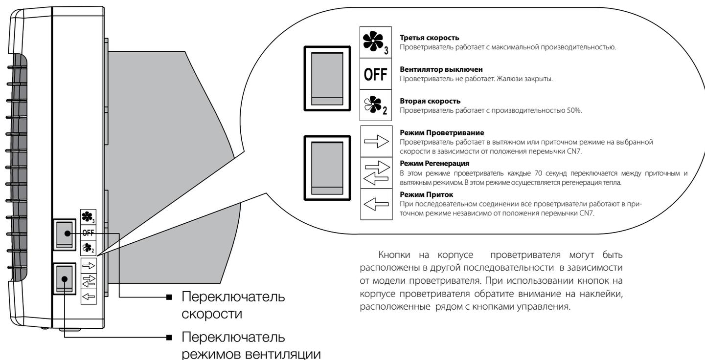
Кнопки на корпусе проветривателя могут быть расположены в другой последовательности в зависимости от модели проветривателя. При использовании кнопок на корпусе проветривателя обратите внимание на наклейки, расположенные рядом с кнопками управления.
