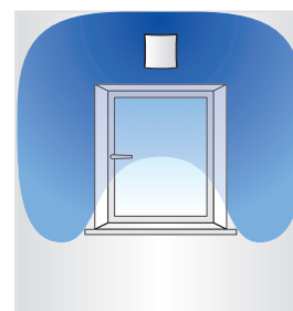
Распределение воздушного потока при различном положении регулятора воздуха
